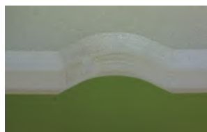
サファイアウェーハ ノッチ研削
