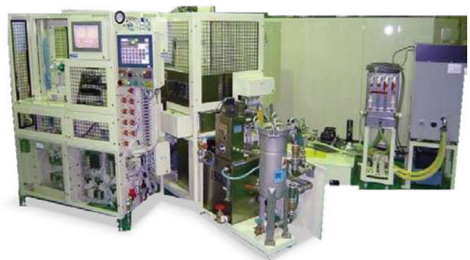
タービンホイール / コンプレッサーホイールバランス測定修正機 Turbine Wheel / Compressor Wheel Balance Measurement and Correcting Machine
